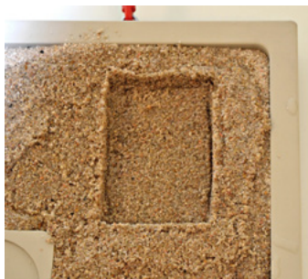
Positionner le bâtiment sur le sol non liquéfié
