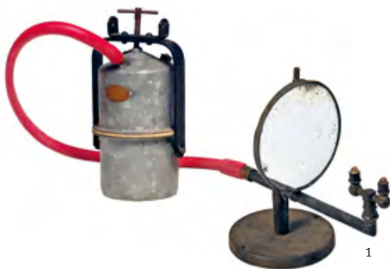
1. Lampe à deux brûleurs avec générateur d'acétylène, vers 1880-1900. Collection Patrice Guérin – diaprojection.fr .
