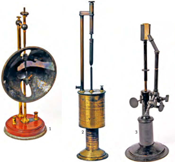
1. Lampe à arc électrique manuel, vers 1840. Les deux baguettes de charbon devaient être rapprochées manuellement au fur et à mesure de leur usure. Collection Patrice Guérin – diaprojection.fr .
