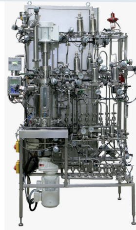
Bioréacteur de laboratoire stérilisable à l'autoclave Tryton™ (1 à 18 L)
