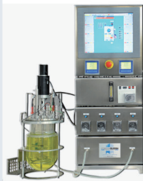
Bioréacteur de laboratoire stérilisable à l'autoclave Tryton™ (1 à 18 L)
